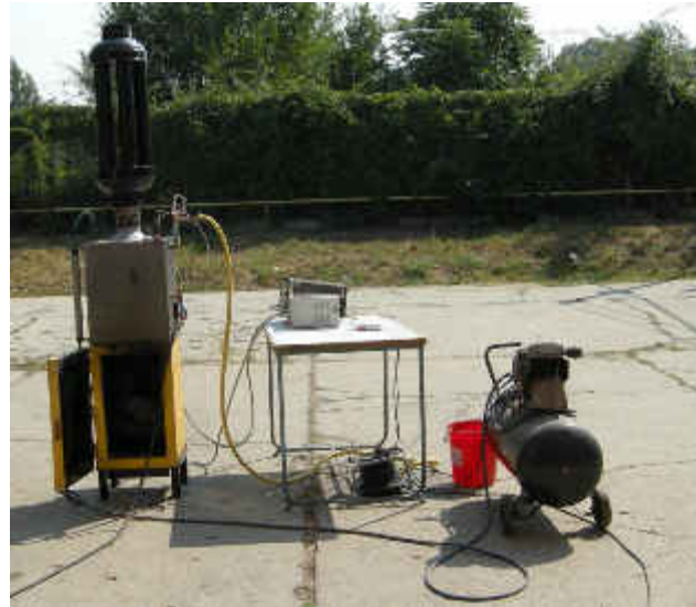
dispozitiv ardere boabe porumb prevazut cu schimbator de caldura cu apa in probe la INMA
