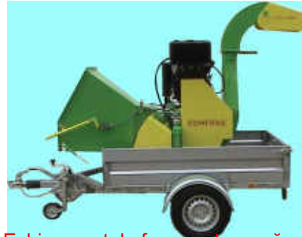
Echipament de fragmentare-mărunțire material lemnos – model experimental dezvoltat în cadrul unui proiect de cercetare - dezvoltare
