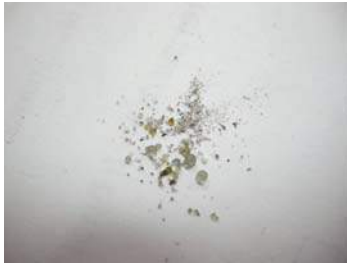
reziduri de ardere a probei din tulpini de porumb ramase dupa determinarea puterii calorice cu bomba calorimetrica la INMA
