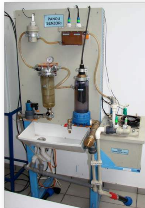
Panou senzori cu baie de termostatare pentru senzorii ioni \text{Cl}^- și ioni \text{Na}^+
