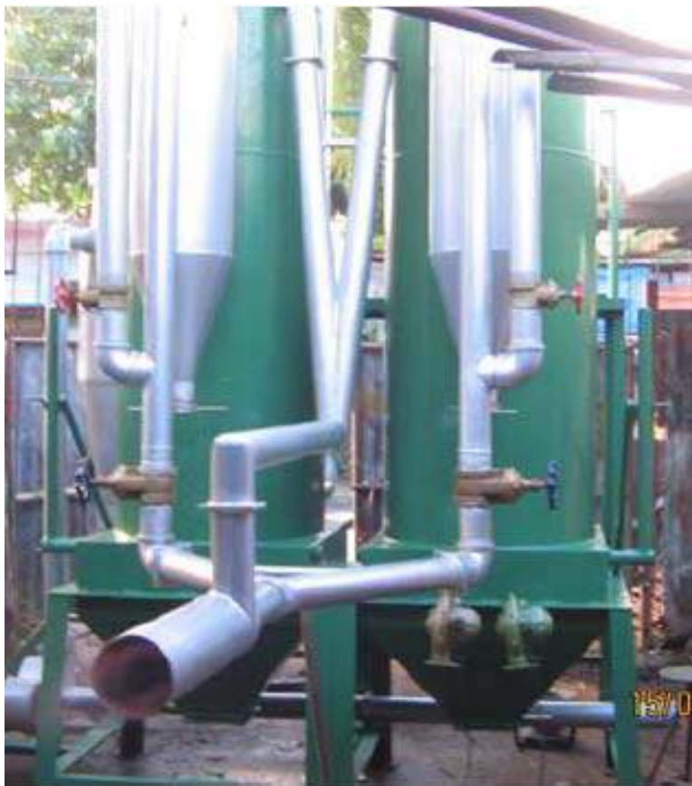
Baterie module TLUD de 2x60 kW pentru un uscător convectiv
