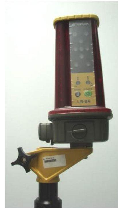
Receptorul laser de cotă LS-B4 montat pe dispozitivul de poziționare TM 1
