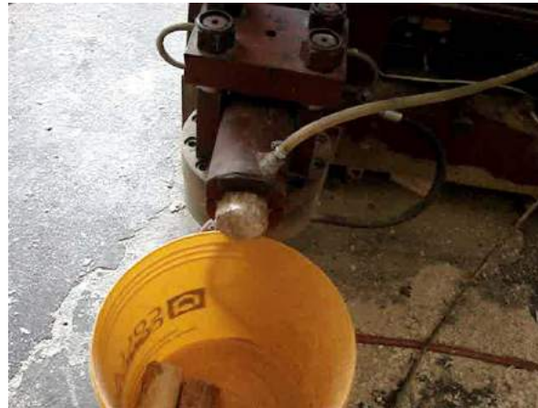
Proces brichetare tulpini de porumb
