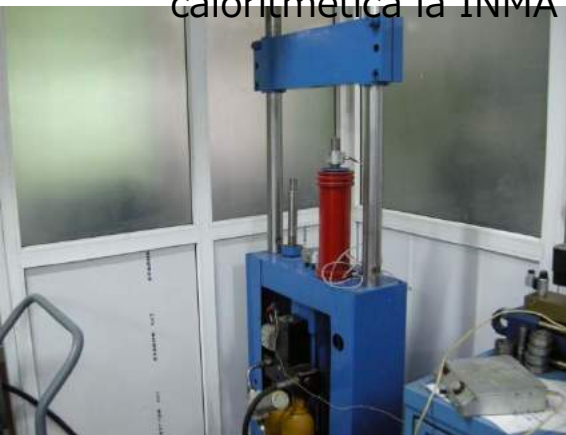
-stand pentru determinarea caracteristicilor de brichetare cu dispozitivul si traductorul de presiune
