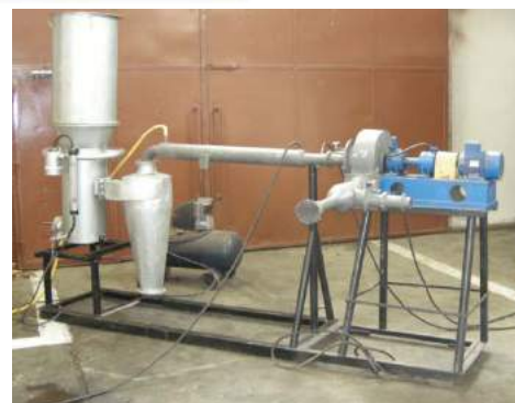
Gazogenul pregatit pentru probe cu brichete si tulpini de porumb la INMA
